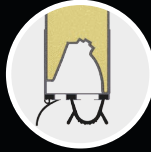
Uszczelka wsuwana w dolny aluminiowy profil
