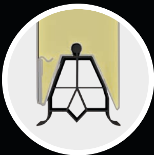
Uszczelka wsuwana w dolny panel
